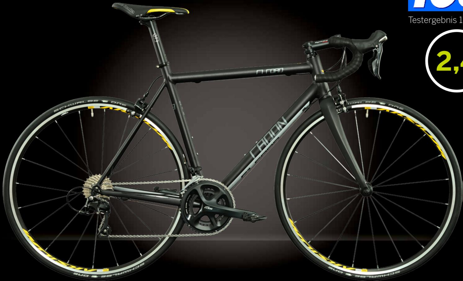
Für den Kampfprijs von 999 Euro verbaut die Bonner Marke eine komplette 105-Gruppe, dazu solide, mit 23 Millimeter breiten Top-Reifen bezogene Aksium-Laufräder sowie gute Anbauteile. Nicht zuletzt der ergonomisch vorbildliche Lenker von Syntace trägt erheblich zum guten Fahreindruck bei. Das ordentlich verarbeitete, sehr steife, schwarz eloxierte Rahmen-Set mit runden Rohren und außen verlaufenden Zügen gibt sich optisch zurückhal-
